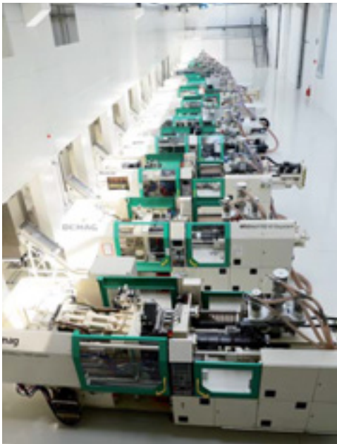
Produktion mit Spritzgießmaschinen in einem partikelarmen Umfeld nach ISO Klasse 8.
